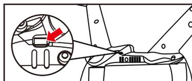
Fernsteuerung EIN, dann X252 einschalten, den Bindeknopf drücken. Leuchtet die LED dauerhaft, ist der Bindevorgang erfolgreich.
