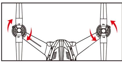
Montieren Sie die Propeller wie gezeigt. Die Pfeilrichtung auf dem Propeller muss mit der Pfeilrichtung auf dem Arm übereinstimmen. Die Muttern entgegengesetzt der Pfeilrichtung von Hand handfest anziehen, diese sichern sich selbst durch die entgegengesetzte Drehrichtung.
